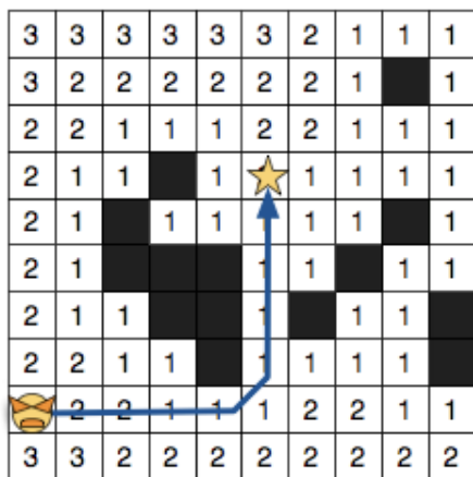
5 pav. „Brushfire“ algoritmu paremtas kelio planavimas [7]
