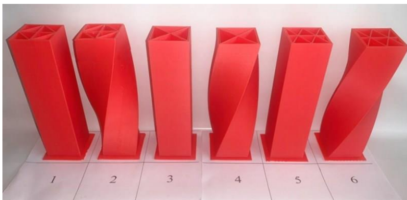
1 pav. Nagrinėjami skirtingų formų kolonų prototipai atspausdinti 3D spausdintuvu
