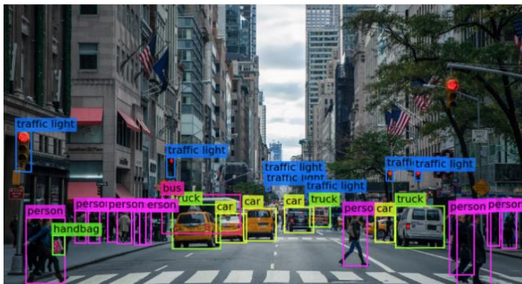
1 pav. Autonominio automobilio vaizdo kamerų fiksuojamas vaizdas ir klasifikuojami jame esantys objektai [2]
