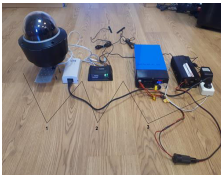
3 pav. Vaizdo fiksavimo ir duomenų perdavimo sistema: 1 – PTZ kamera; 2 – duomenų perdavimo įranga; 3 – maitinimo įranga
