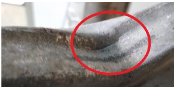
6 pav. Įtrūkimas antrą kartą lenkiamoje skersinėje sijoje
