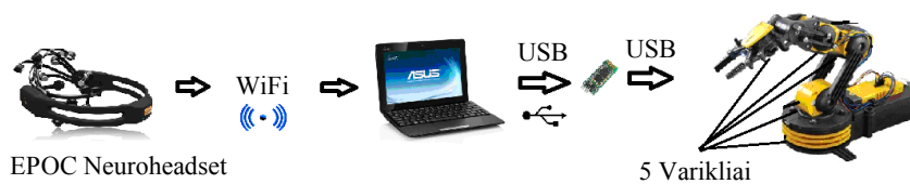
7 pav. Principinė manipulatoriaus valdymo schema su EPOC neuroheadset
