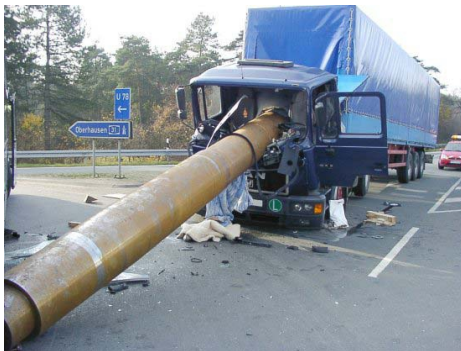
2 pav. Staigiai stabdant, blogai pritvirtinti plieniniai vamzdžiai prakirto priekinį bortą ir vairuotojo kabiną [4]
