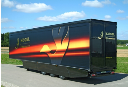
3 pav. Puspriekabė su aerodinaminiais gaubtais [4]
