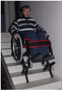
1 pav. Rankomis varomo, laiptais kopiantis vežimėlis neįgaliajam [1]
