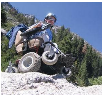
6 pav. Motorizuotas, kalnuotom vietovėm skirtas, neįgaliojo vežimėlis [6]
