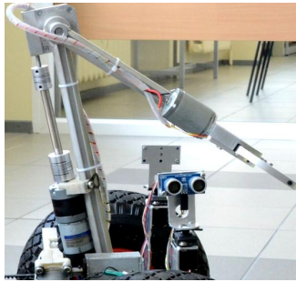
1 pav. Dviejų laisvės laipsnių manipulatoriaus: a – kinematinė schema; b – pagaminta konstrukcija
