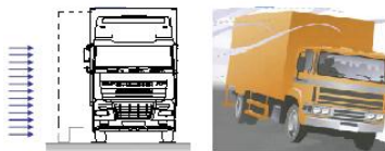
1 pav. Sunkvežimio elgsena papūtus gūsingam šoniniam vėjui: a – sunkvežimio slydimas; b – sunkvežimio vortimas
