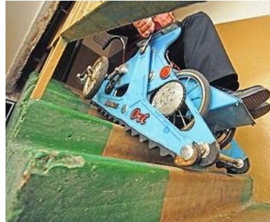
2 pav. Motorizuotas, vikšrų pagalba kopiantis laiptais, vežimėlis neįgaliajam [2]
