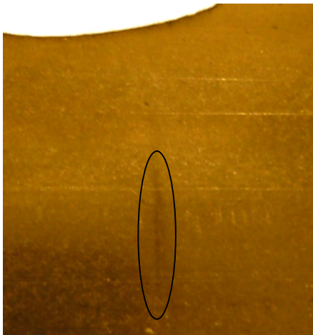
3 pav. Mikroįtrūkimo atsiradimas
