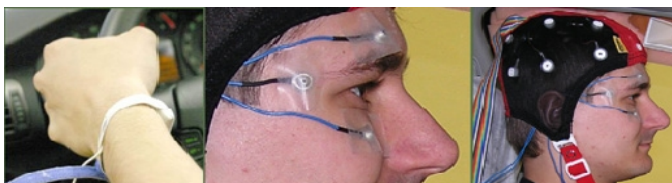
1 pav. Vairuotojas bandymo metu prijungiamas prie širdies dažnio fiksavimo įrenginio, EOG elektrodu bei užmaunama EEG kepurė
