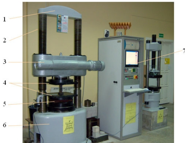
4 pav. Presas PMM-250: 1 – nejudanti traversa, 2 – sraigtinės kolonos, 3 – judanti traversa, 4 – plokštės, 5 – hidrocilindras, 6 – korpusas, 7 – kompiuterinis valdymas
