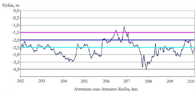
3 pav. Laivakelio ašies išilginis profilis (202– 210 km), naudojant MS Excel programinę įrangą
