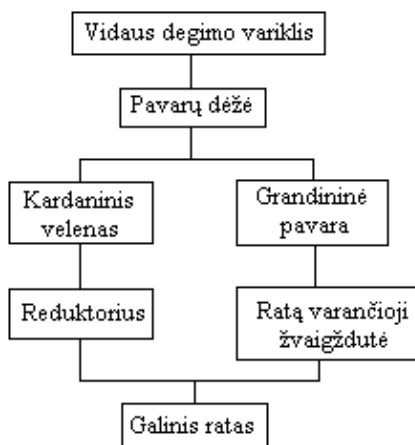
4 pav. Motorinės dviratės transporto priemonės sukimo momento perdavimo schema
